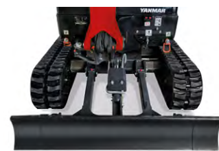
Train de roulement allongé : 1320 mm
